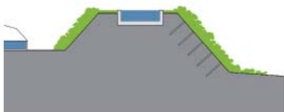
La contención de tierras mediante taludes vegetales o mediante muros que son tapizados posteriormente con recubrimientos de tierra vegetal (debidamente estabilizados), permiten conseguir una adecuada transición entre un frente costero rocoso y el terreno donde comienza la vegetación arbustiva.
