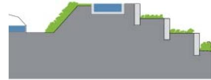
Dividir la contención del salto de cota a resolver en varios niveles o terrazas reduce el impacto y tamaño del elemento de contención y aleja la escala del elemento de la de las grandes infraestructuras (contenciones en carreteras por ejemplo), aproximándolo a la escala propia de las parcelas agrarias del entorno rural.
