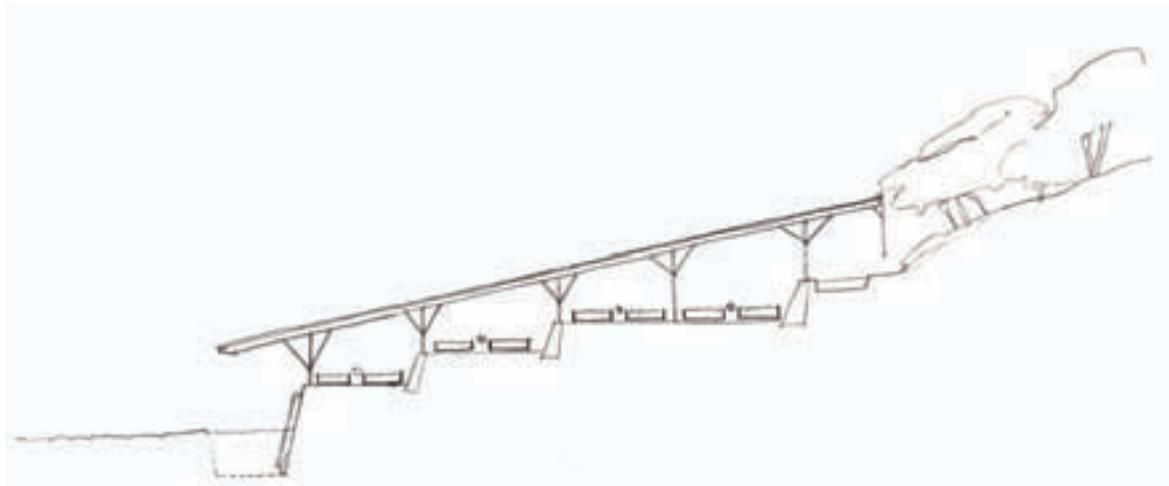
El aterrazamiento o abancalamiento del nivel de soporte se unifica con una cubierta inclinada que da cobertura a toda la instalación.
