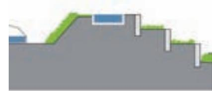
Dividir la contención del salto de cota a resolver en varios niveles o terrazas reduce el impacto y tamaño del elemento de contención y aleja la escala del elemento de la de las grandes infraestructuras (contenciones en carreteras, por ejemplo), aproximándolo a la escala propia de las parcelas agrarias del entorno rural.
