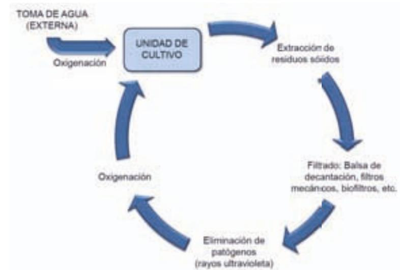
Figura 5. Esquema de un posible Sistema de recirculación para la acuicultura
