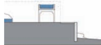
En entornos urbanos, la formación de la explanada suele realizarse mediante rellenos que dan lugar a plataformas horizontales, generalmente formadas por elementos de piedra u hormigón.
