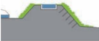
La contención de tierras mediante taludes vegetales o mediante muros que son tapizados posteriormente con recubrimientos de tierra vegetal (debidamente estabilizados), permiten conseguir una adecuada transición entre un frente costero rocoso y el terreno donde comienza la vegetación arbustiva.
