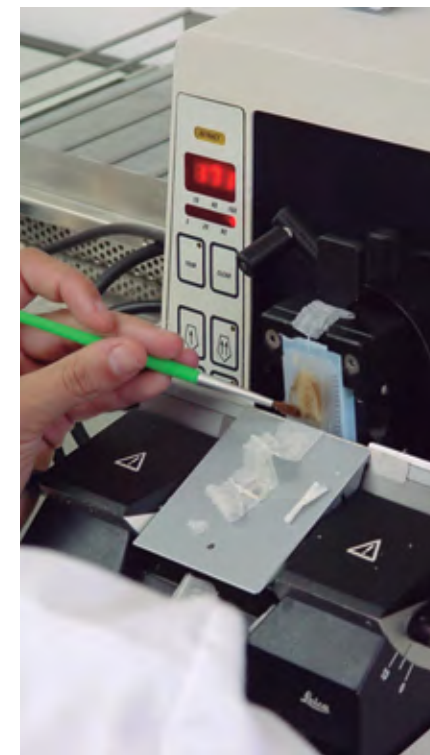
Unidade de Patoloxía. Proceso de corte ao micró-tomo dos bloques de parafina.
