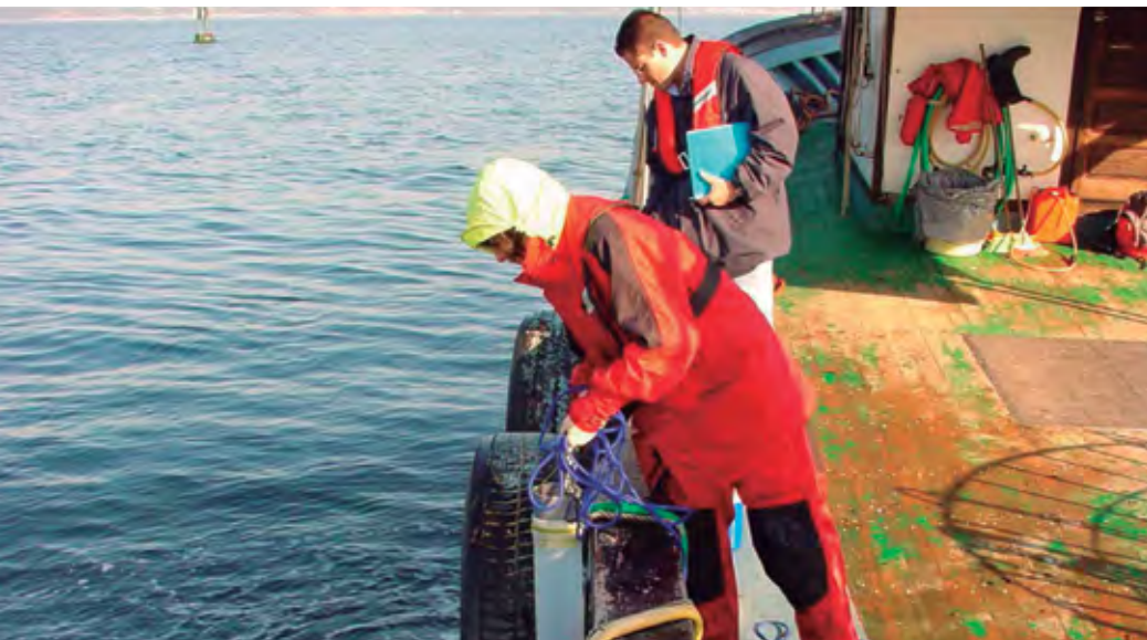
Recollida de mostras de auga de mar cunha manga de fitoplancto desde o barco bateiro empregado para recoller mostras de mexillón nas bateas.
