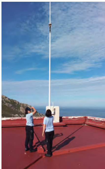
Antena emisora do Radar HF na estación de Cabo Prior.
