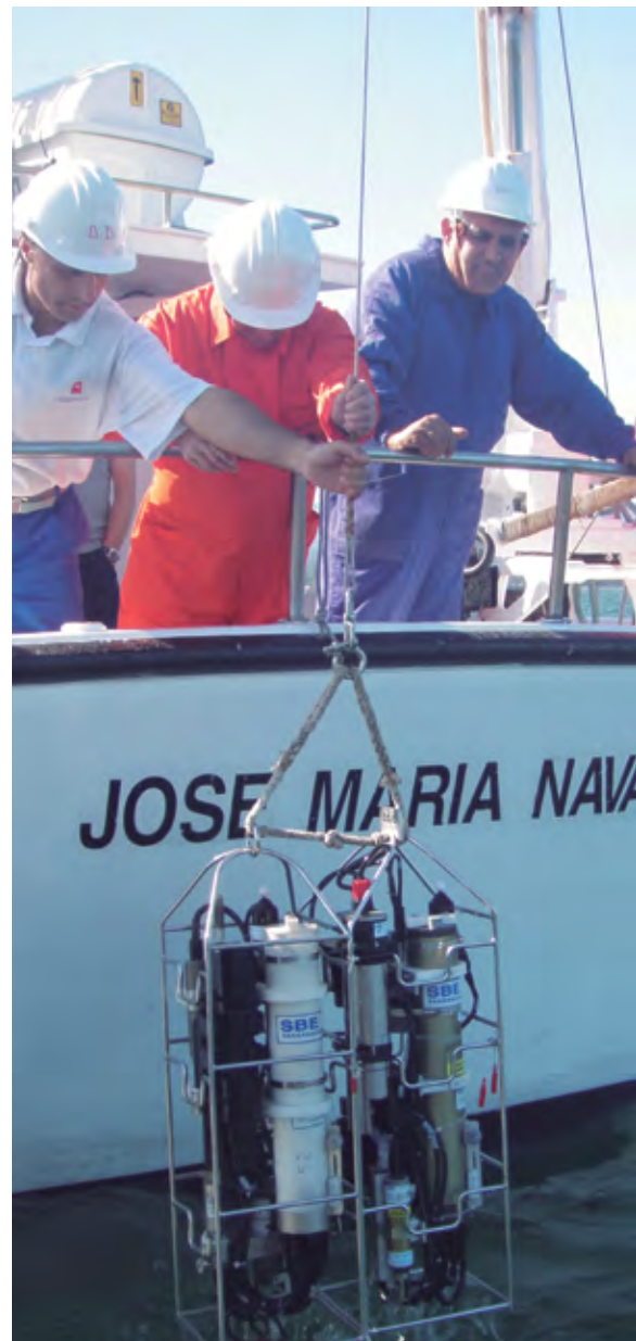
Medición de variables oceanográficas (CDT).
