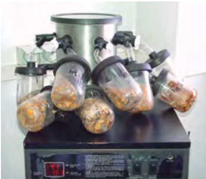
Proceso de liofilización de mostrás de mexillón.
